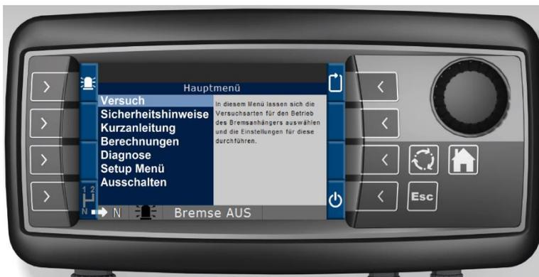
Die Bedienung erfolgt über Fernbedienung mit Farbdisplay und eine menügeführte Benutzeroberfläche. Funktionstasten und ein haptischer Multifunktionsdrehknopf für die Hauptfunktionen ermöglichen eine intuitive Nutzung der zahlreichen Funktionen.
